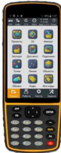
HCE320 - это профессиональный полевой контроллер, оснащённый крупным сенсорным экраном диагональю 5,5 дюйма, который позволяет работать даже при ярком солнечном свете. Восьмиядерный процессор и 2 Гб оперативной памяти обеспечивают быструю работу с большим количеством данных, в т.ч. растровыми или векторными подложками.
